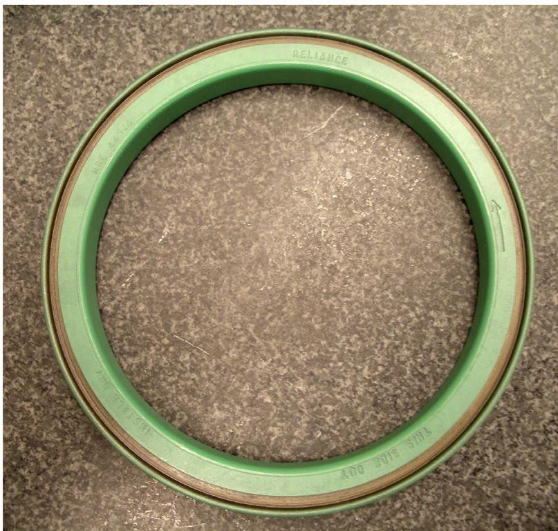
Los repuestos actuales de retenes para cigüeñal para los motores John Deere serie 300 y 350 utilizan una pista integrada y se conocen como retenes de tipo “unitarizado” o “cassette”. Estos retenes se considerarán inutilizables si se han separado de sus pistas, y si eso sucede, se deberán desechar y reemplazar. Para asegurar la instalación correcta del retén ES NECESARIO utilizar la herramienta de instalación adecuada (JDE30040 o equivalente).
